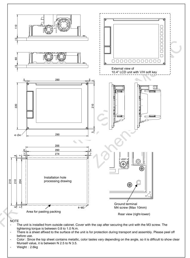
Fig. A (d) LCD-mounted type control unit - 10.4" LCD unit \* for PANEL *i*H
