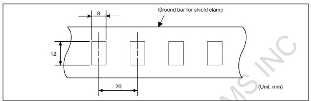
Fig. 3.4.6 (d) Ground bar for shield clamp (hole arrangement and dimension drawing)
