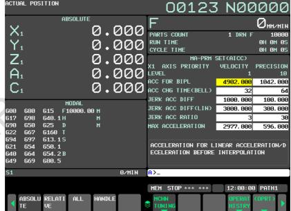
Fig. 12.27 (b) Machining parameter setting screen
